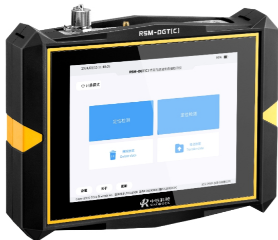
图2-1 RSM-DGT(C)桥梁孔道灌浆质量检测仪
