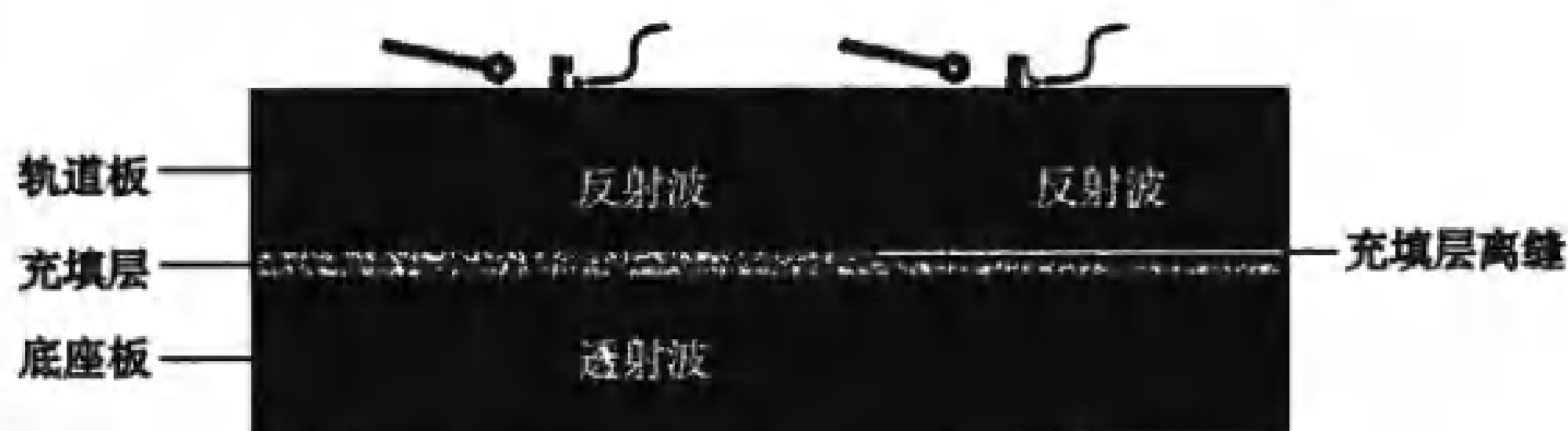
说明图 6.3.10 无砟轨道充填层离缝检测示意图
