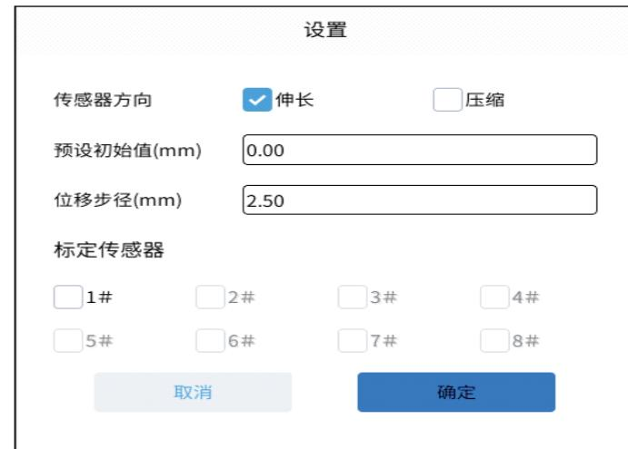
图3-5 (c) 数显位移传感器标定设置界面图
