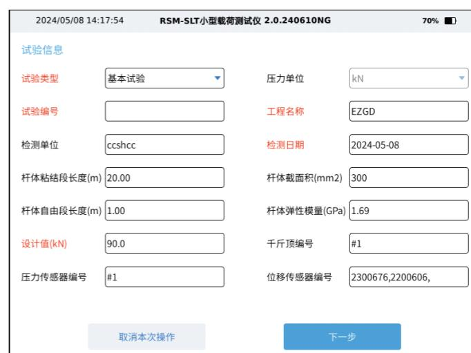
图3-3-3 (c) 试验引导-锚杆载荷试验信息设置界面图
