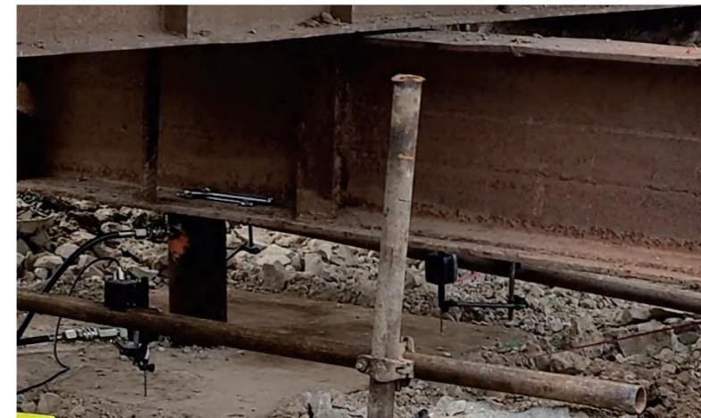
图5-2 (c) 现场位移传感器安装图
