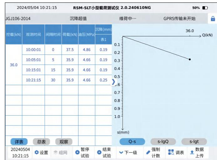
图3-3-5 (d) 试验采集-q曲线界面图
