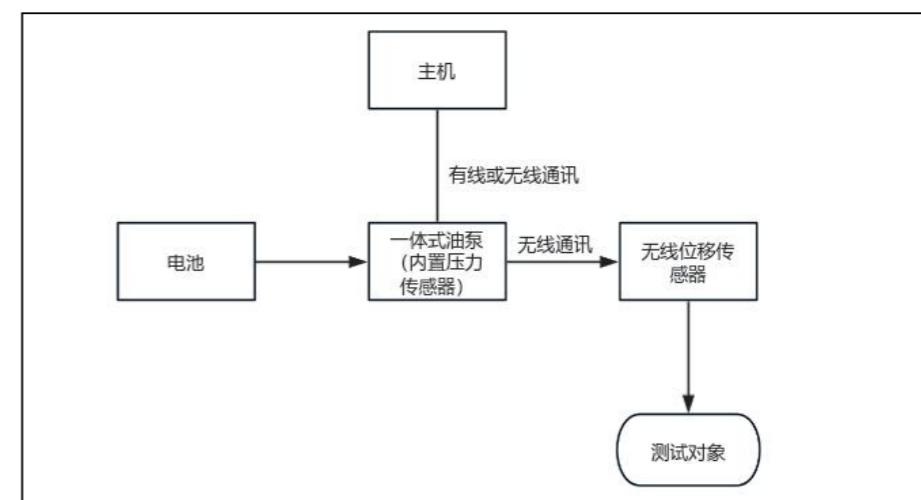
图2-2 (b) RSM-SLT (C) 小型载荷测试仪（无线位移）示意图
