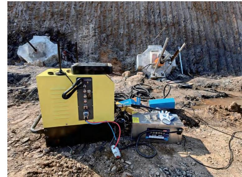
图6-2 (b) 现场一体式油泵及电池连接图
