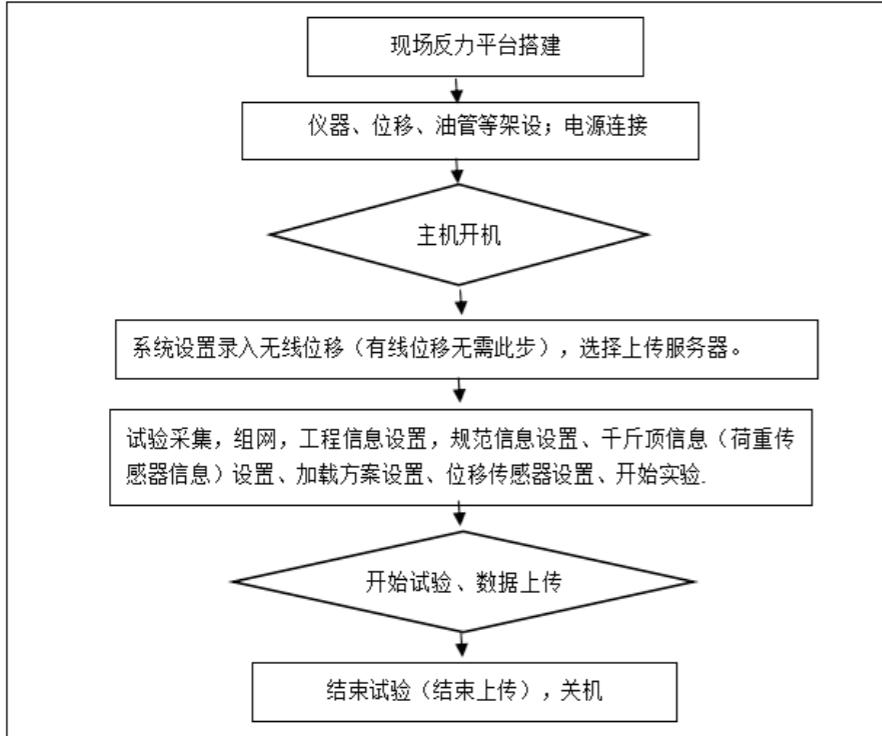
图3-9 现场试验基本流程
