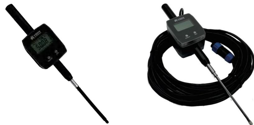
图2-1 (c) RSM-SLT (C) 小型载荷测试仪无线（左）和有线（右）位移传感器
