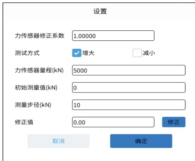
图3-5 (i) 荷重传感器标定设置界面图
