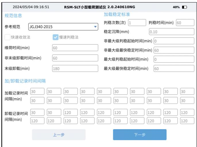
图3-3-3 (e) 试验引导-桩和地基试验规范信息设置界面图
