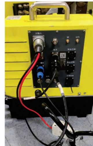
图5-2(b) 现场锂电池以与微型泵连接示意图
