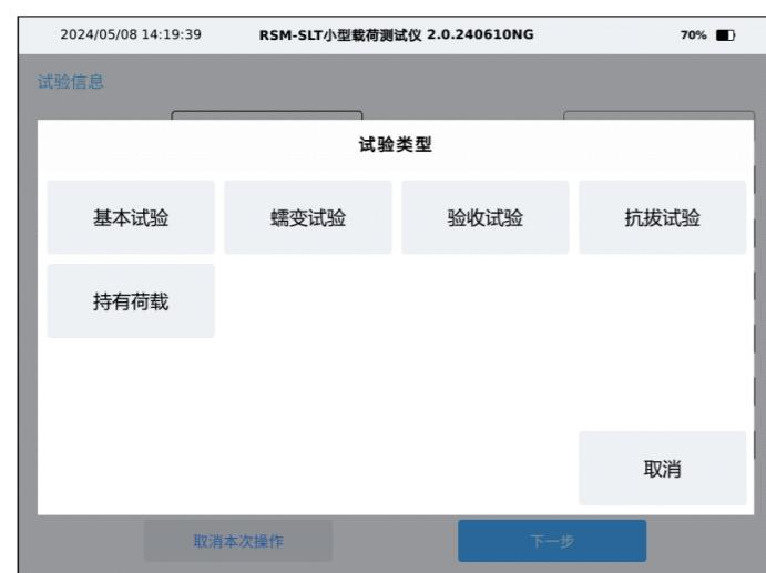
图3-3-3 (e) 试验引导-锚杆载荷试验类型选择
