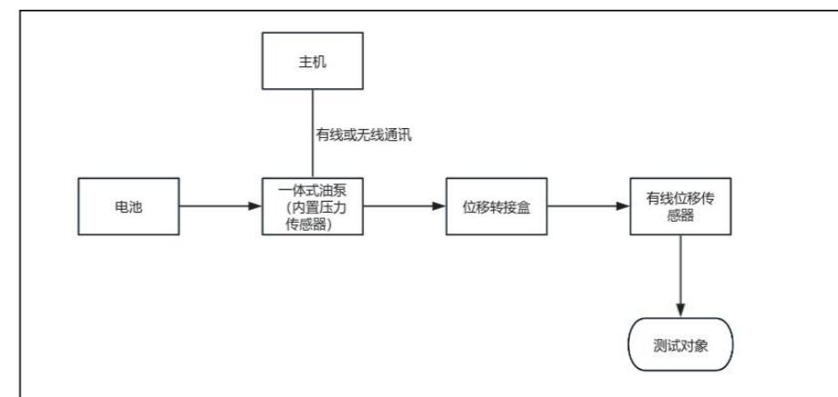
图2-2 (a) RSM-SLT (C) 小型载荷测试仪（有线位移）示意图
