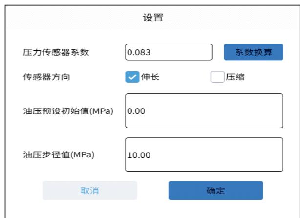
图3-5 (f) 压力传感器标定设置界面图
