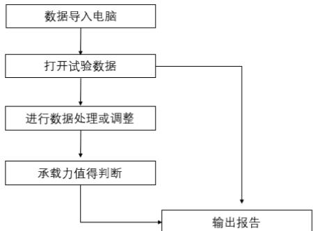
图4-3 RSM静载分析软件基本流程
