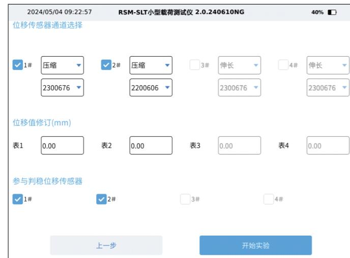
图3-3-3 (g) 桩和地基试验引导-位移传感器设置界面图
