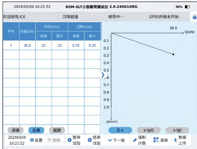
图3-3-5 (b) 试验采集-数据总表界面图
