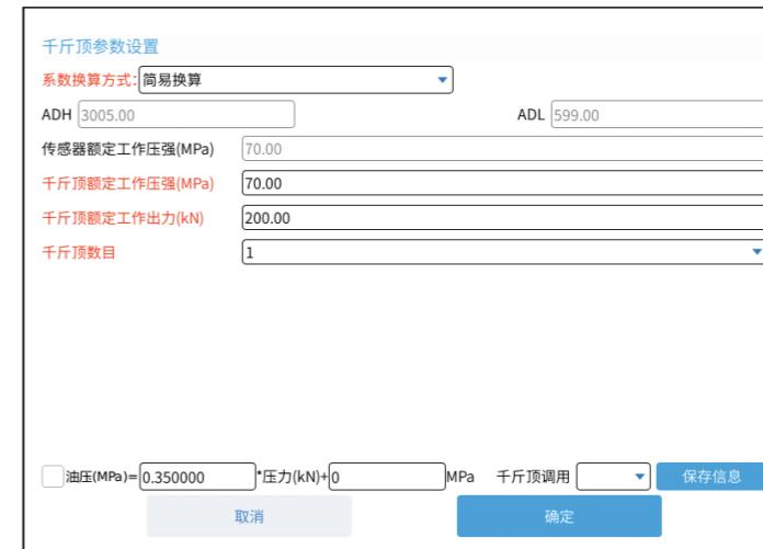
图3-5 (g) 压力传感器标定系数换算界面图
