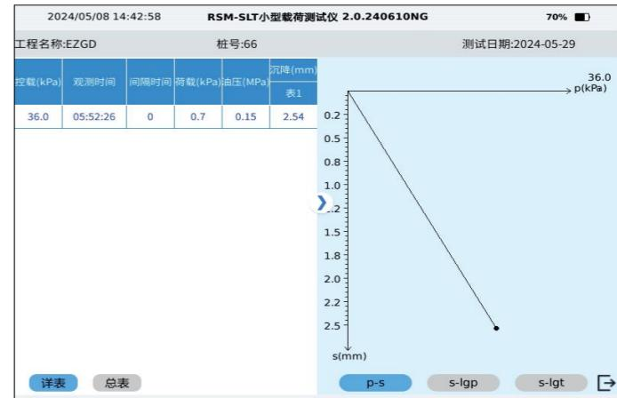
图3-4 (d) 桩数据显示界面图
