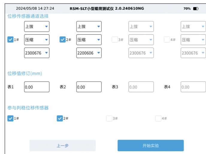
图3-3-3 (h) 锚杆载荷试验引导-位移传感器设置界面图
