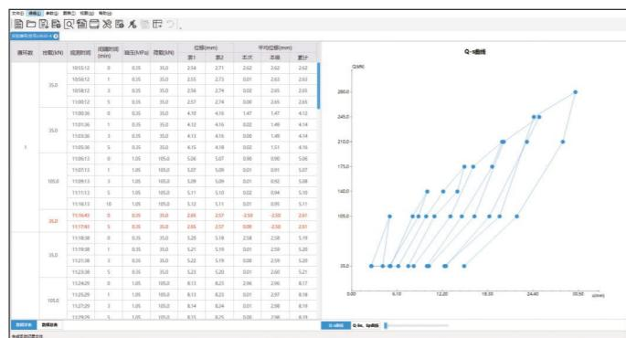
图4-2 (b) RSM锚杆载荷试验-静载分析软件主界面图
