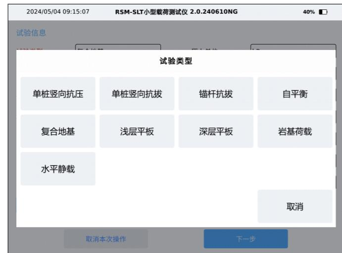
图3-3-3 (d) 试验引导-桩和地基试验类型选择
