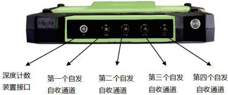
图2-2 RSM-SY8(C)基桩超声波CT成像测试仪前侧面
